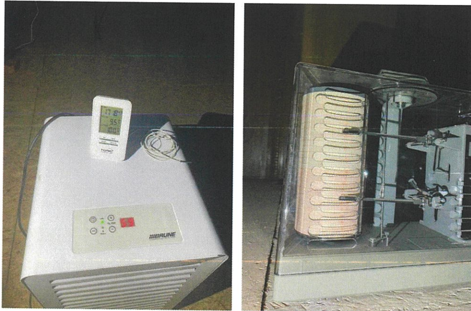
Foto 29, 30. Aparate de monitorizare a temperaturii și umidității (termohigrografe) și dezumidificatoare amplasate doar în sălile P20 Sala de consiliu și P35 Bibliotecă.
